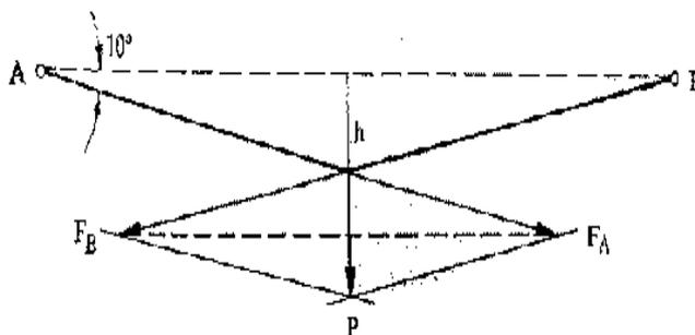
Рис. 21. Силы, действующие на горизонтально натянутую веревку при нагружении
