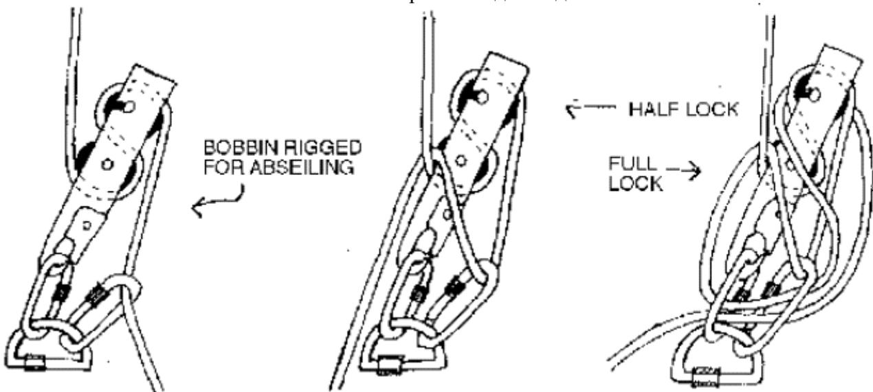
Рис.58. Использование бобины при спуске.
