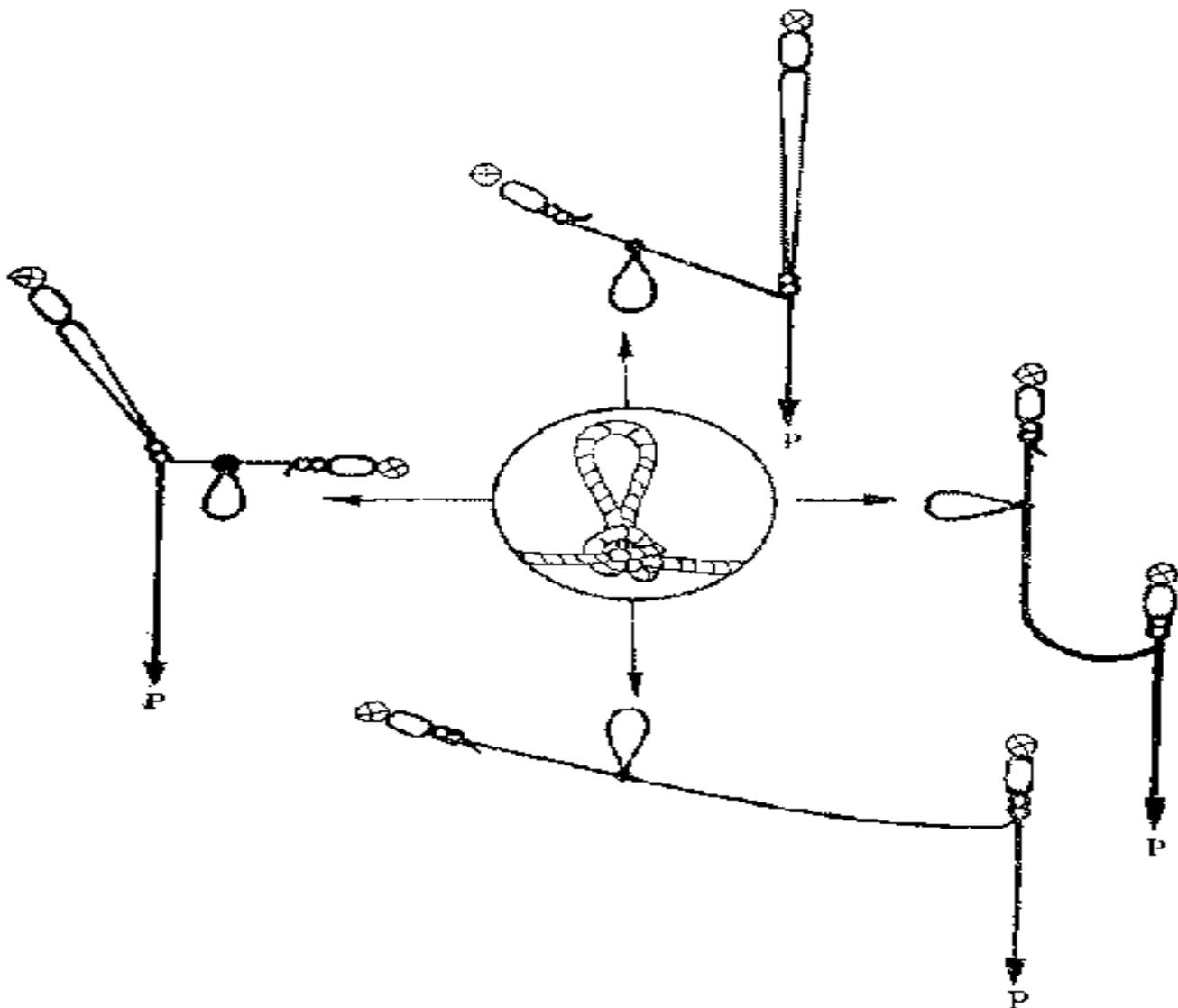
Рис. 16. Амортизирующий узел и схемы креплений, при которых он используется
