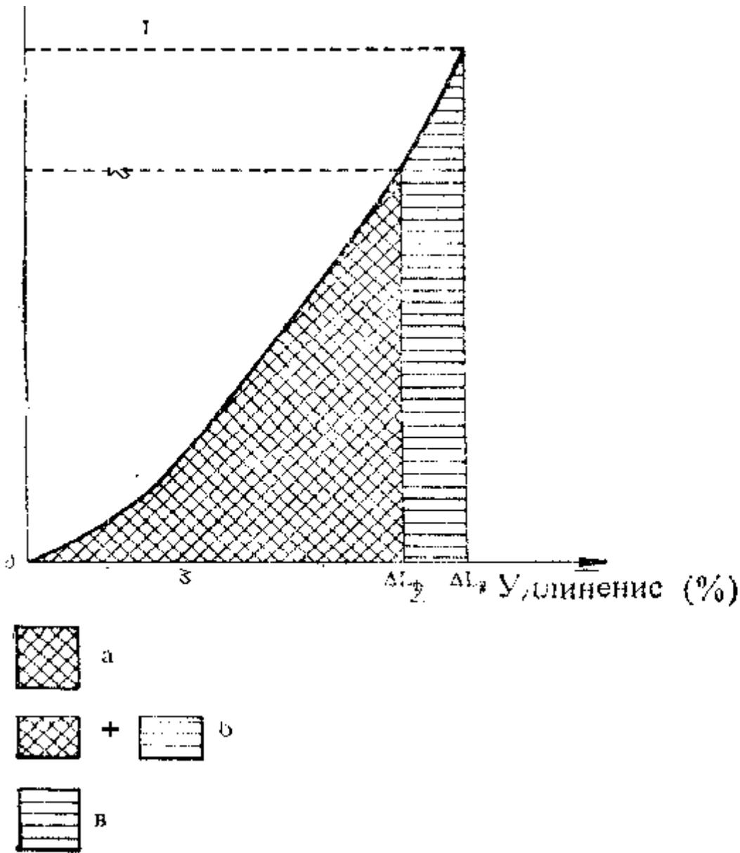
Рис. 6. Надежность веревки: 1 - практическая прочность на разрыв; 2 ПДН при амортизации удара; а - энергия падения, поглощенная веревкой; б - энергия, необходимая для разрыва веревки с улами, мокрой, грязной и т.д.; в - зона надежности веревки. Чем больше значение ПДН (2) приближается к практической прочности (1), тем больше сужается эта зона, т.е. уменьшается надежность веревки, и наоборот
