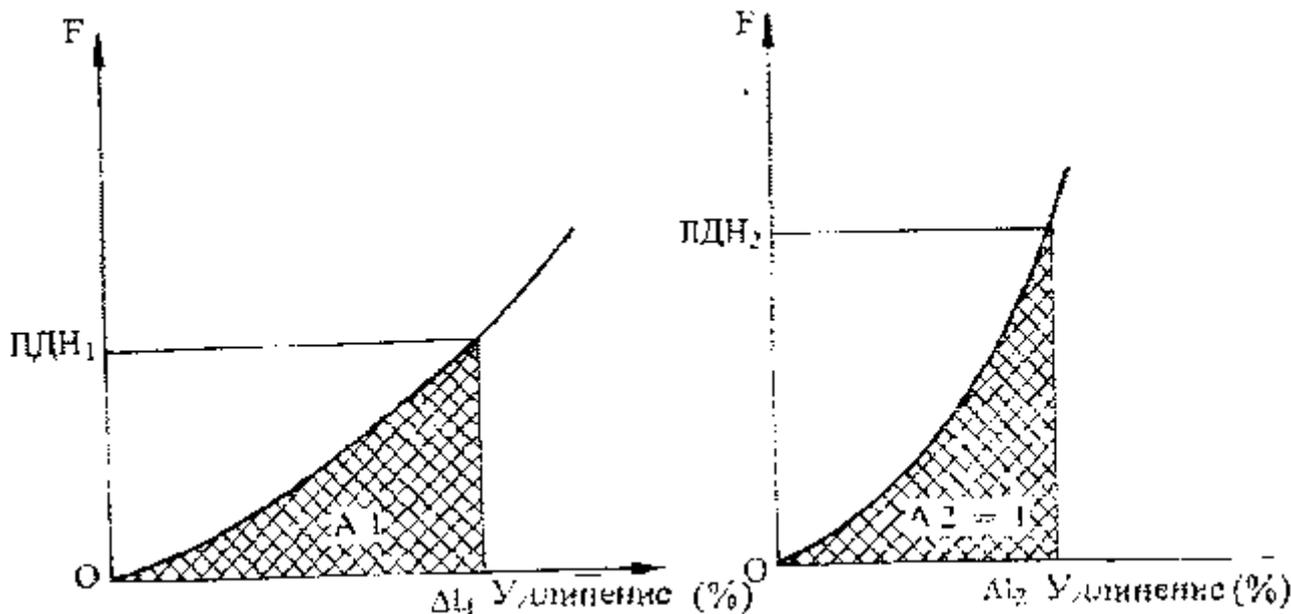
Рис. 3. Зависимость ПДН от динамических свойств веревки.
