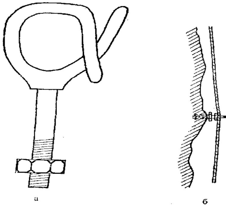
Рис. 18. Отклонитель: а - общий вид; б - способ применения
