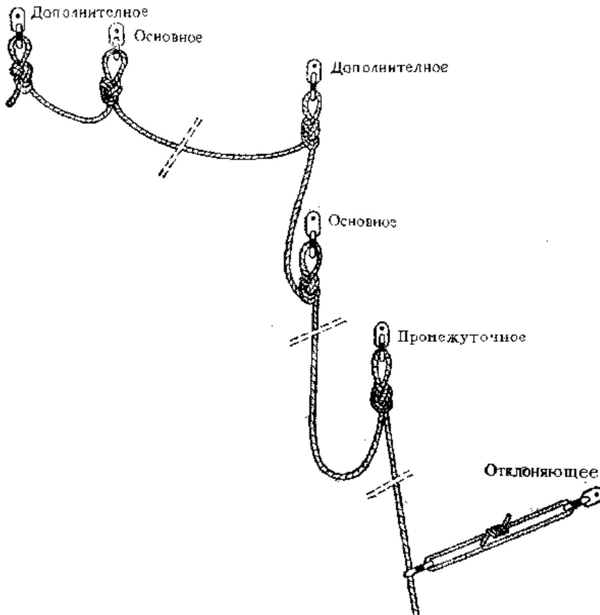
Рис. 10. Виды креплений (дополнительное, основное, промежуточное, отклоняющее)
