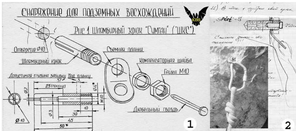
Рис.8. Шлямбурный крюк "ШКС" - основа первого периода освоения нами SRT в 1985-88 годах, успешно применявшийся и при подземных восхождениях (фото и рис. К.Б.Серафимова):
