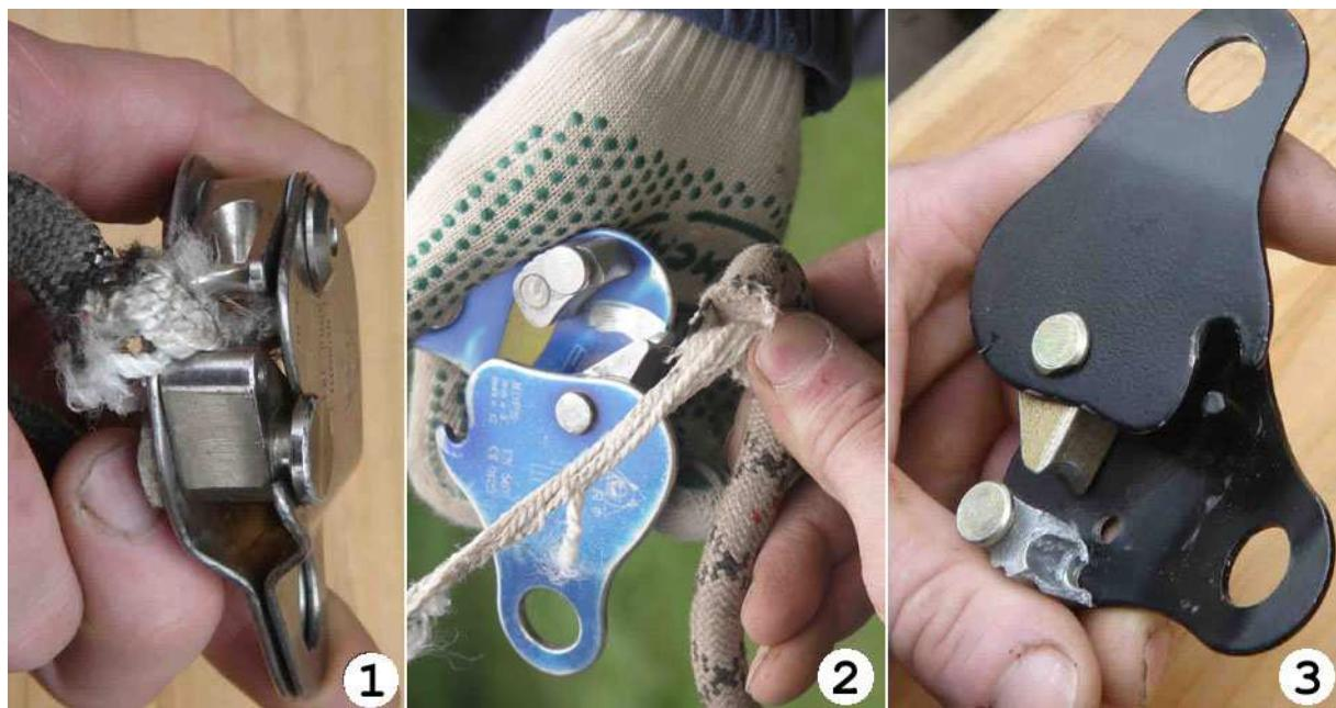
**Рис.79.** Коромысловые зажимы типа "Капелька" при проскальзывании перерезают веревку по принципу паяльника из-за узко концентрированного разогрева кулачков в зоне трения (фото Влада Еремеева, Москва)
