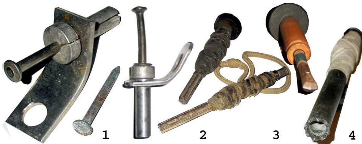
**Рис.5.** Шлямбурные крючья и пробойники 80-х годов:
