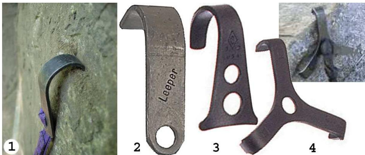
Рис.16. Скайхуки для работы на рельефе и универсальные:
