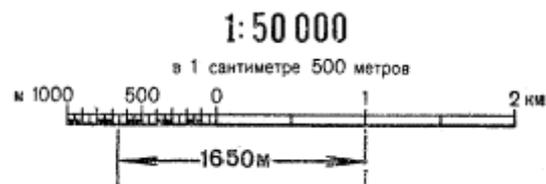
**Рис. Измерение расстояния с помощью линейного масштаба и циркуля**
